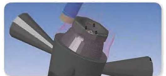
Usinage automatique en 3+2 axes des connexions
