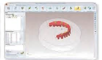
Affectation automatique des gammes d'usinage liées à la référence de l'implant et aux matériaux
