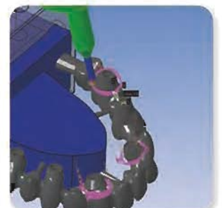
Reprise automatique des contre-dépouilles en 5 axes.
