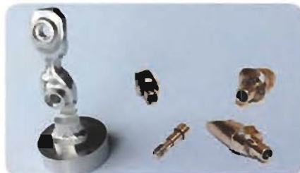
Usinage automatique de contre-dépouilles en 5 axes
